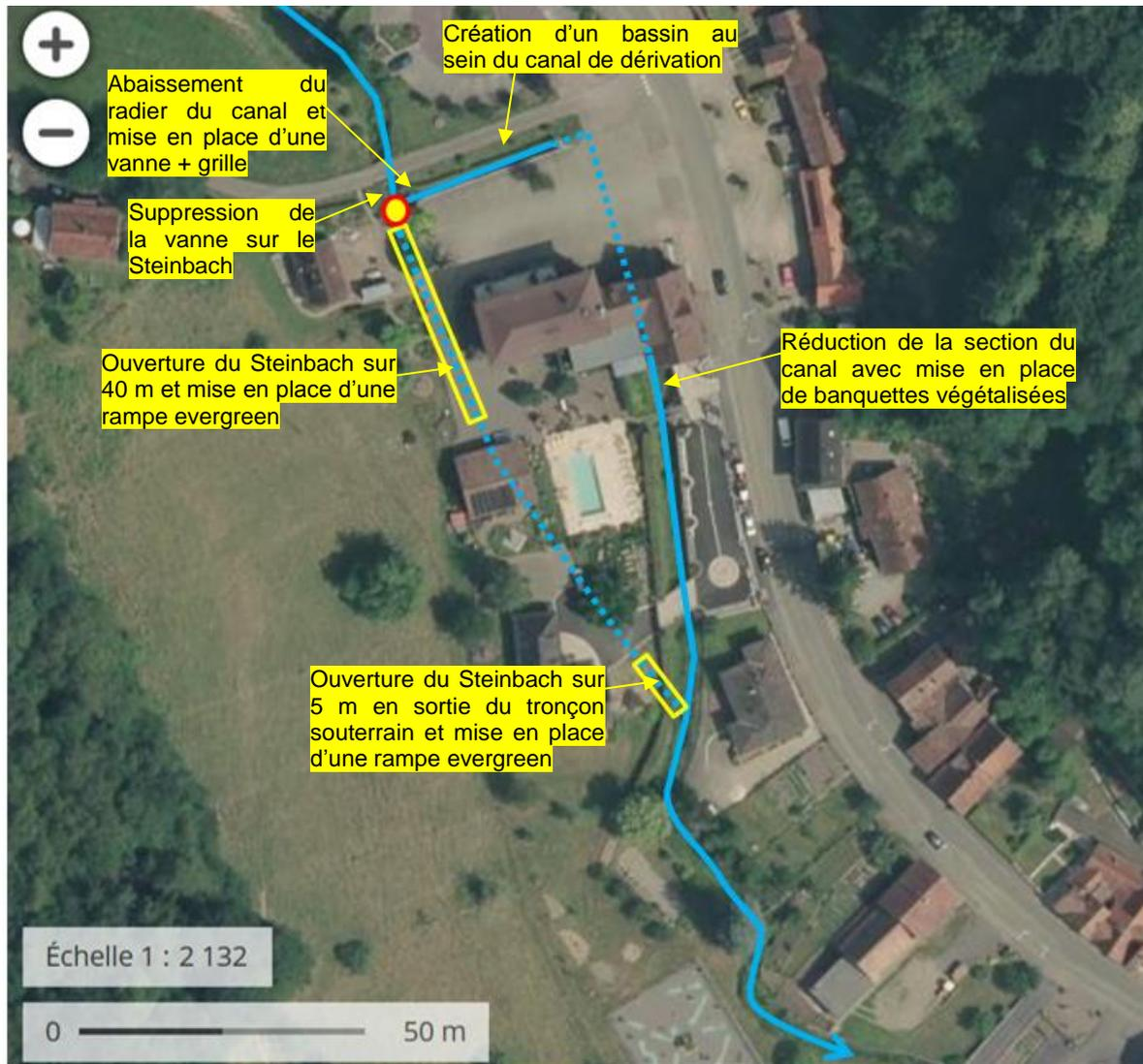
**Fig. 29. Aménagements projetés pour le scénario n°1 – Option 1 – Rampes evergreen**
