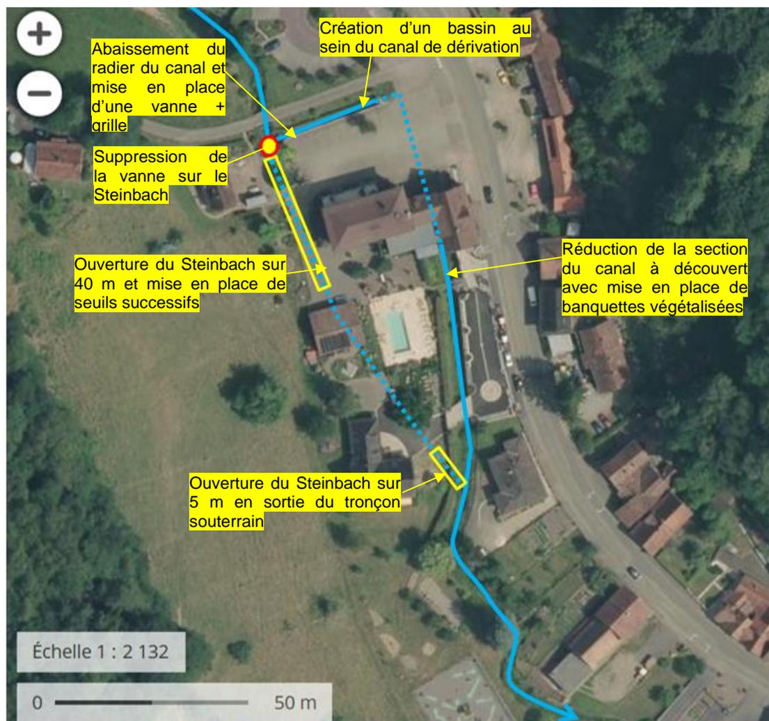
**Fig. 38. Aménagements projetés pour le scénario n°1 -2 – Seuils successifs**
