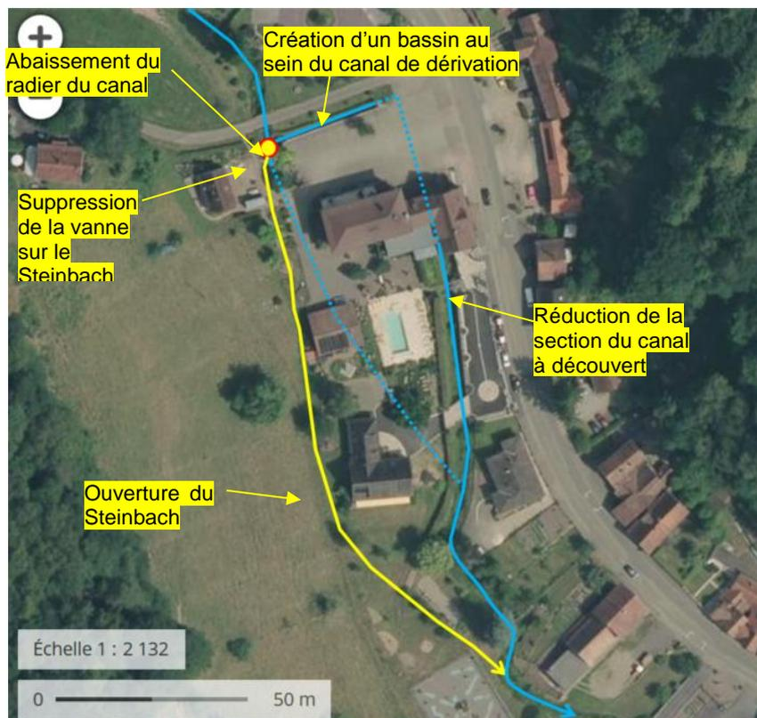
**Fig. 45. Aménagements projetés pour le scénario n°2 -Ouverture totale du Steinbach**
