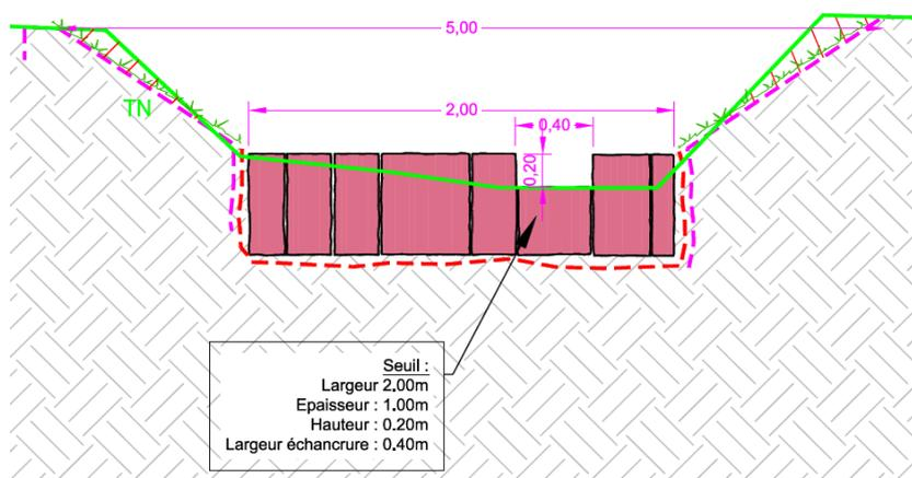
**Fig. 15. Extrait de la coupe du seuil de répartition à échancrure de fond**
